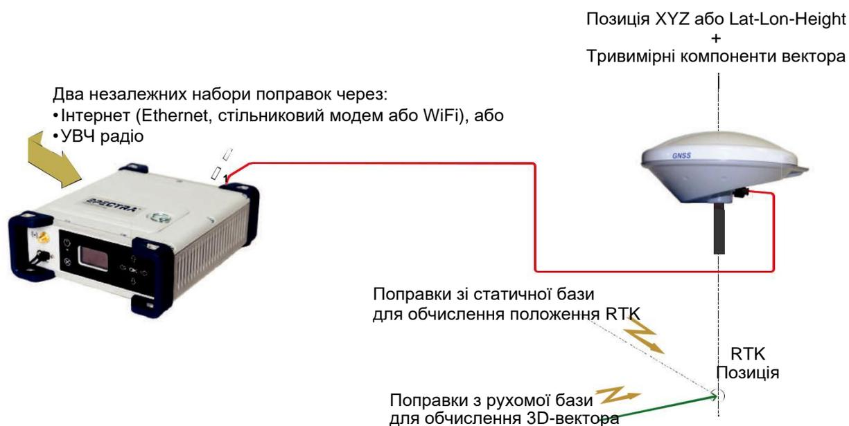
На екрані загального стану приймача відобразиться «receiver **FIXED**» ((фіксоване рішення)(з коротким Float (плаваючим) часом переходу)) під час обчислення позиції в режимі RTK. Розрахована позиція RTK відображається після натискання
