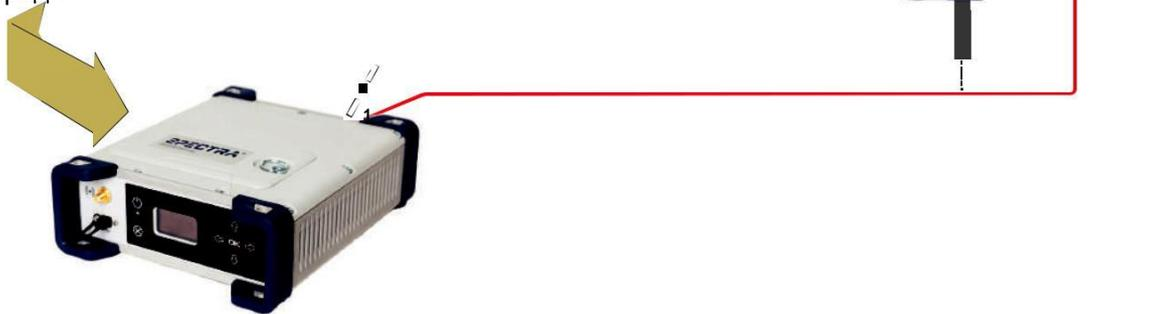
На екрані загального стану приймача відобразиться «receiver **FIXED**» (фіксоване рішення) (з коротким Float (плаваючим) часом переходу) або DGPS під час обчислення положення відповідно в режимі RTK або DGPS. Розрахована позиція відображається після натискання
