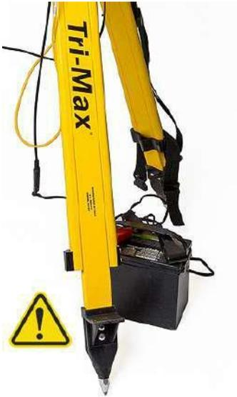
Коли приймач використовується в польових умовах як база для роумінгу, він може живитися від стандартного автомобільного акумулятора, наприклад, якщо ви вживаєте таких запобіжних заходів:
