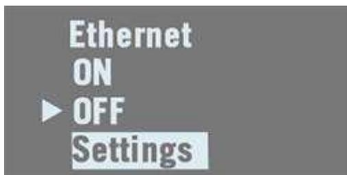
Якщо ви виділите третій параметр (Налаштування) і натисніть ОК, ви зможете редагувати кожен із наведених нижче параметрів. Після встановлення параметра натисніть ОК, щоб зберегти його, а потім натисніть кнопку зі стрілкою вниз, щоб отримати доступ до наступного параметра:
