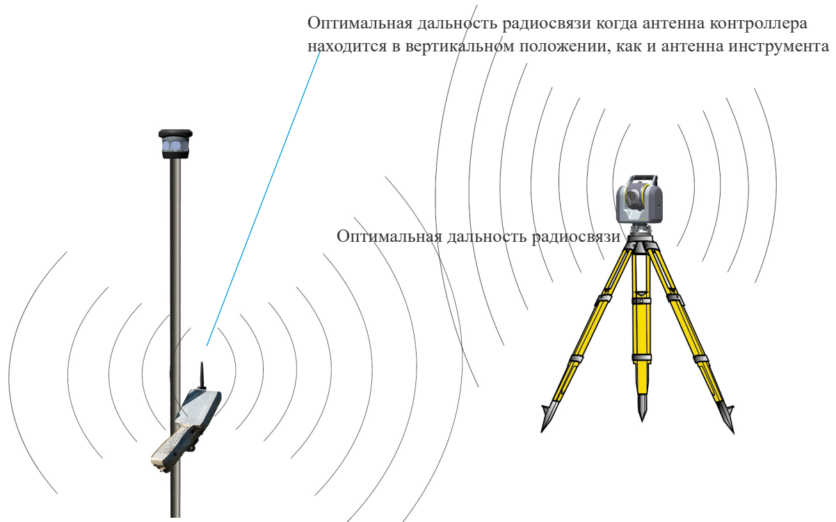
Рисунок 4.8 Оптимальная дальность радиосвязи, если антенна контроллера находится в вертикальном положении, как и антенна инструмента
