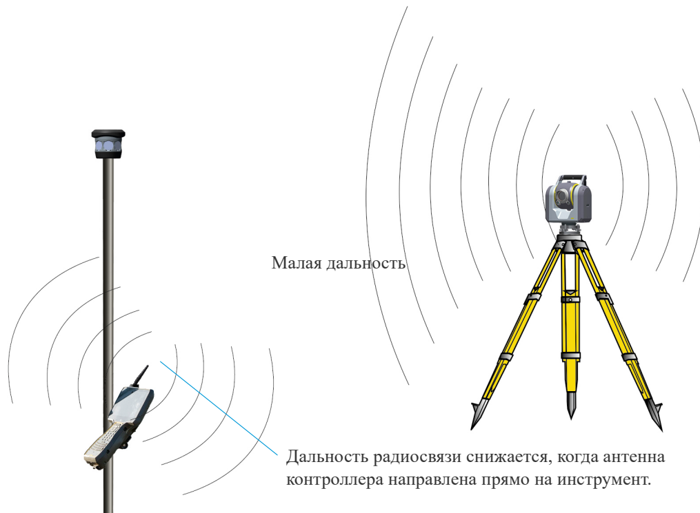
Рисунок 4.7 Снижение дальности радиосвязи, если антенна контроллера находится не в вертикальном положении, как антенна инструмента
